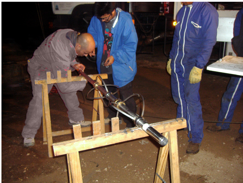
Regulación de los centralizadores de la sonda ABI.
